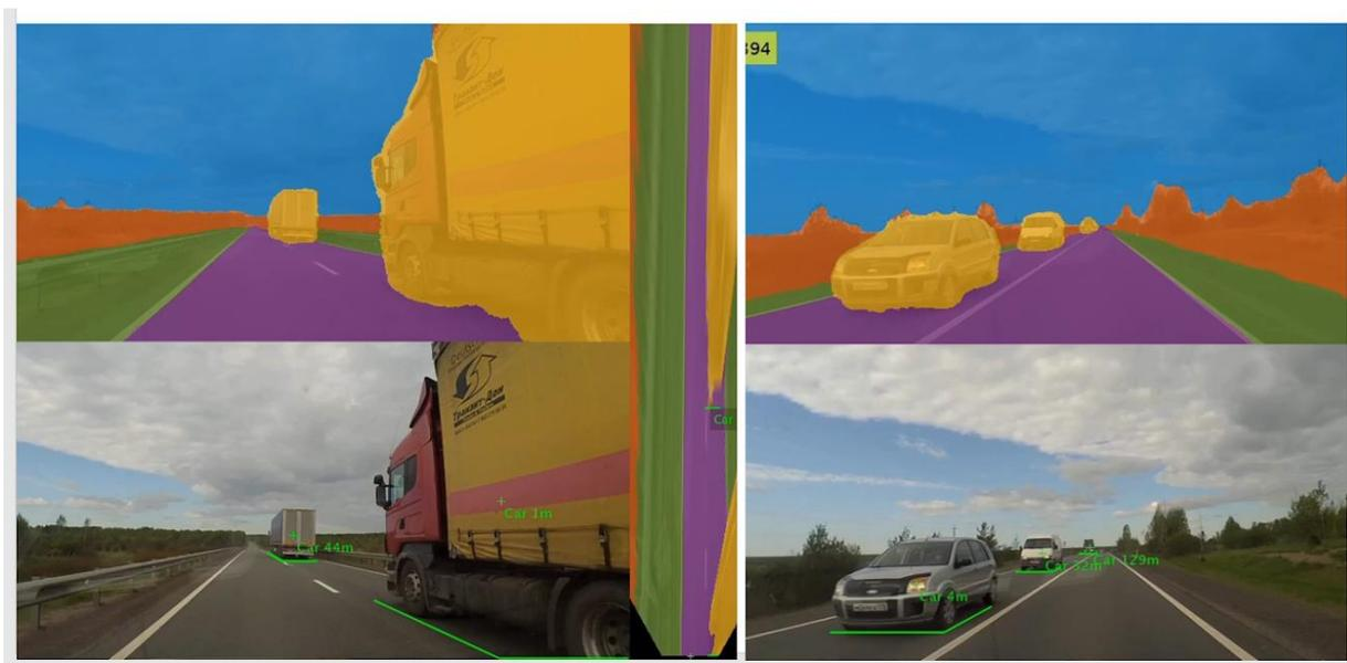
Рисунок 7. Пример измерения расстояния до автомобилей.
